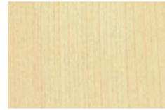
**【カナダ桧】** アテが少なく、水に強い青森ひばに近い芳香性をもつ米ひば材を使用。樹高は30m、直径は1mくらいになります。用途としては建築材、内装材、造作材、建具材、土台角外部材料等にも使用されます。(当社では「米ひば」を「カナダ桧」という商品名で取り扱っております。)
